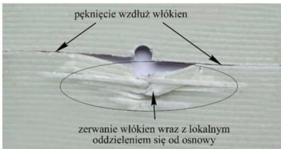
Rysunek 11. Uszkodzenie struktury kompozytu włóknistego w okolicy otworu [93].
