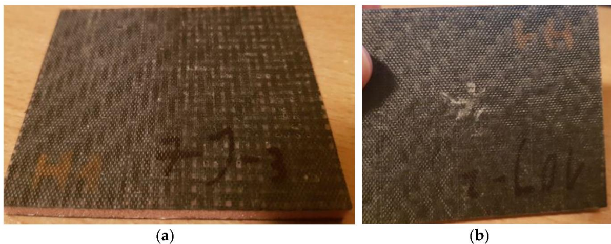
Rysunek 46. Wygląd kompozytu po uderzeniu przy: (a) energii 7 J i (b) energii 10 J [166].
