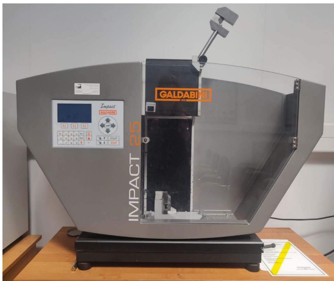
Rysunek 56. Młot Charpy'ego Galdabini Impact 25.
