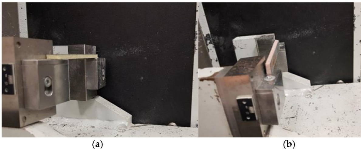
Rysunek 45. Próbkę umieszczoną do badania udarności w warunkach: ( a ) obciążenia krawędziowego i ( b ) obciążenia płaskiego [166].
