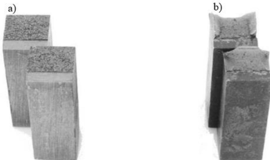
Rysunek 55. Przełom a) kruchy, b) plastyczny.
