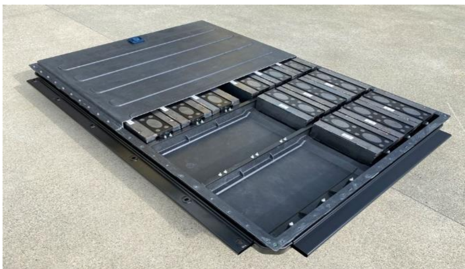
Rysunek 1.19. Obudowa baterii z zastrzeżonymi materiałami CSP [113]
