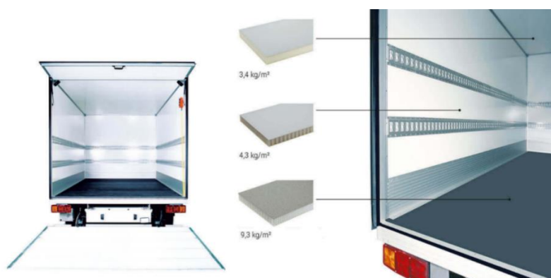
Rysunek 1.23. Wnętrze samochodu dostawczego z zastosowanymi kompozytami przekładkowymi firmy Design Composite GmbH [120]
