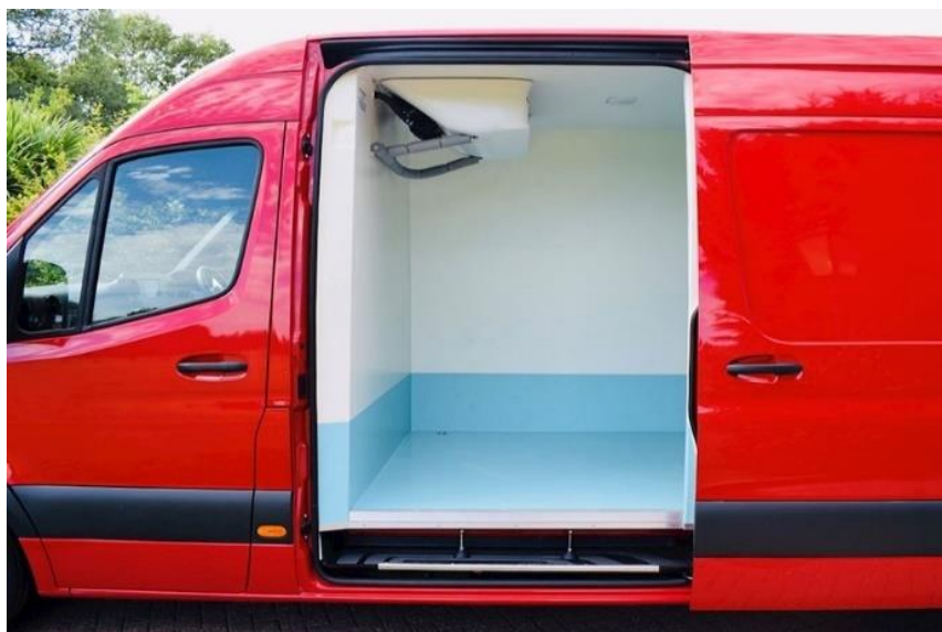
Rysunek 1.21. Wnętrze pojazdu transportowego z funkcjami kontroli temperatury [117]
