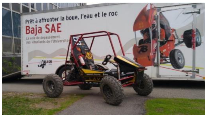
Rysunek 1.17. Prototyp Baja SAE z Université Laval wykonany techniką HLU [18]
