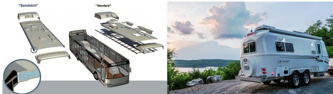
Rysunek 1.22. Technologia sandwich dla autobusów i przyczep kempingowych [118, 119]
