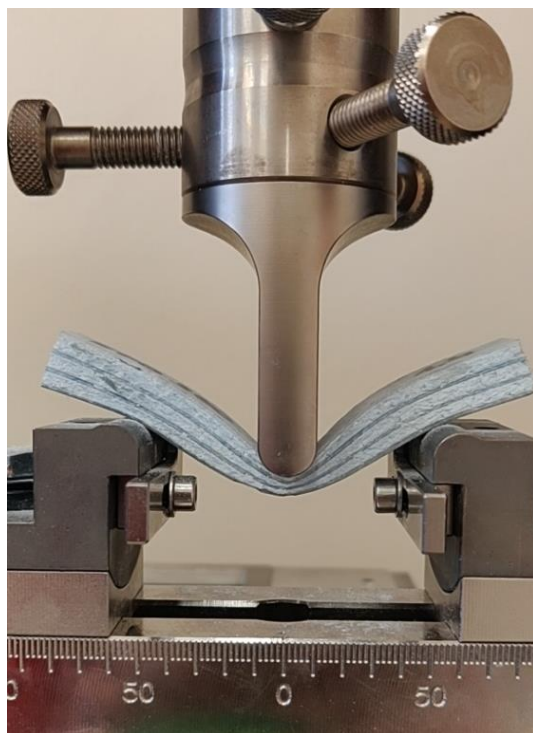
Rysunek 5.8. Ugięcie kompozytu z modyfikowaną osnową przy maksymalnym odkształceniu
