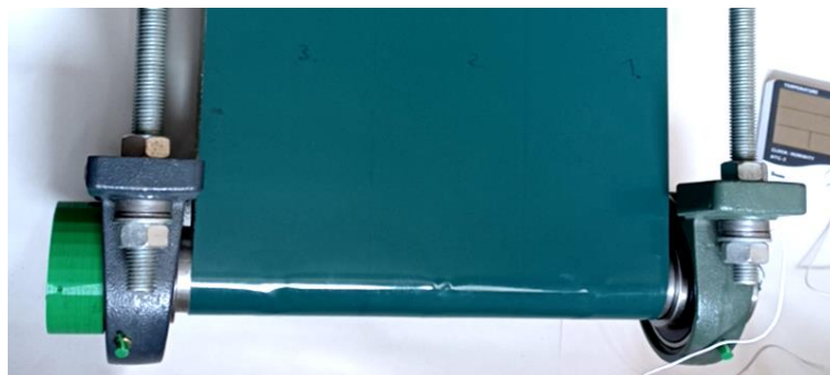
Rys. 4.27. Bęben zwrotny (oprac. własne)
