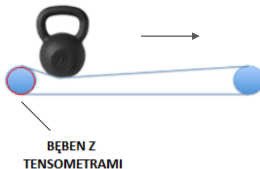
Rys. 5.70. Ugięcie taśmy pod obciążeniem (oprac. własne)
