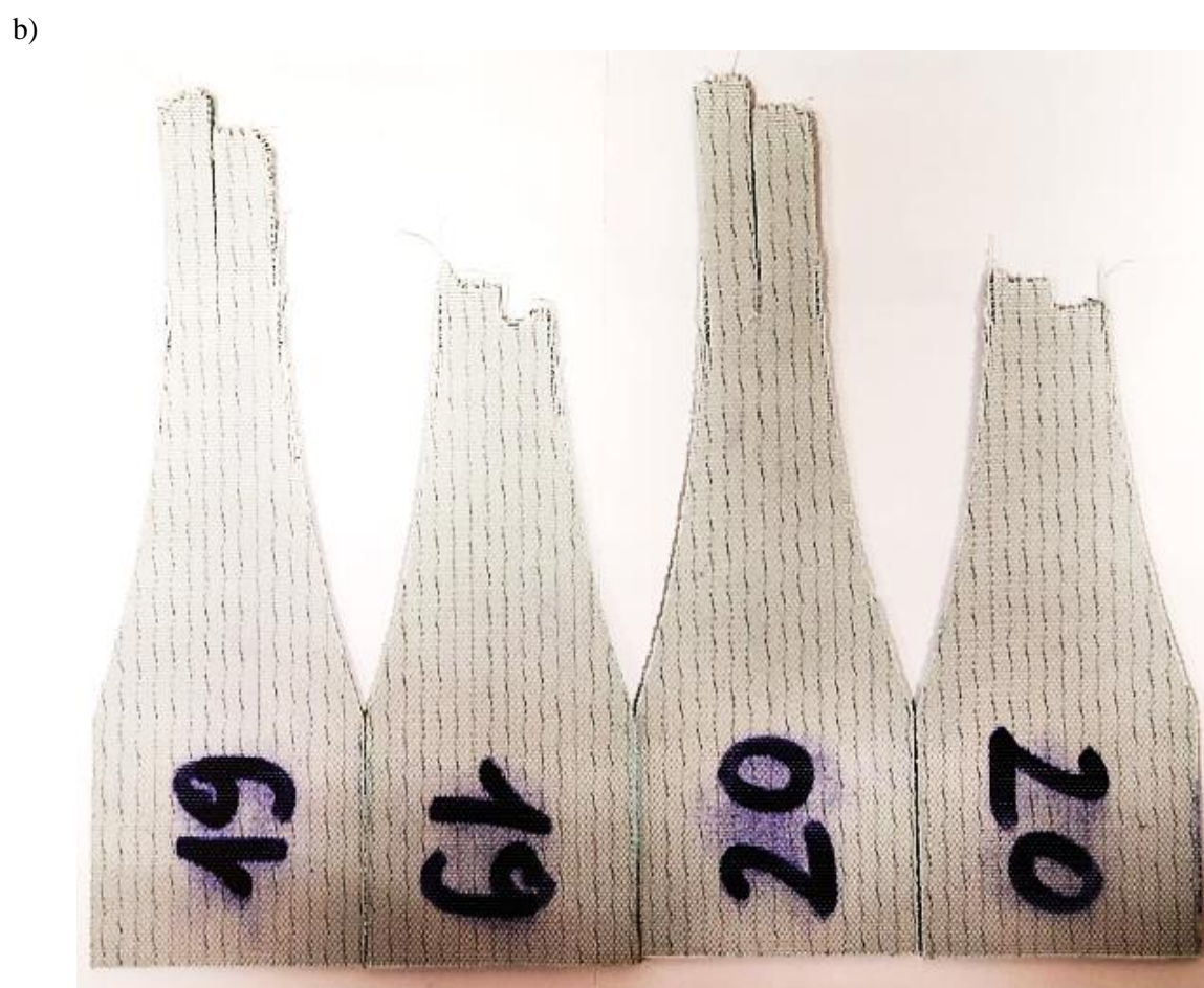
Rys. 5.141. Wyniki statycznego rozciągania, uszkodzenie UW I a) wykres, b) zdjęcia próbek po zerwaniu (Ryba i in., 2024)
