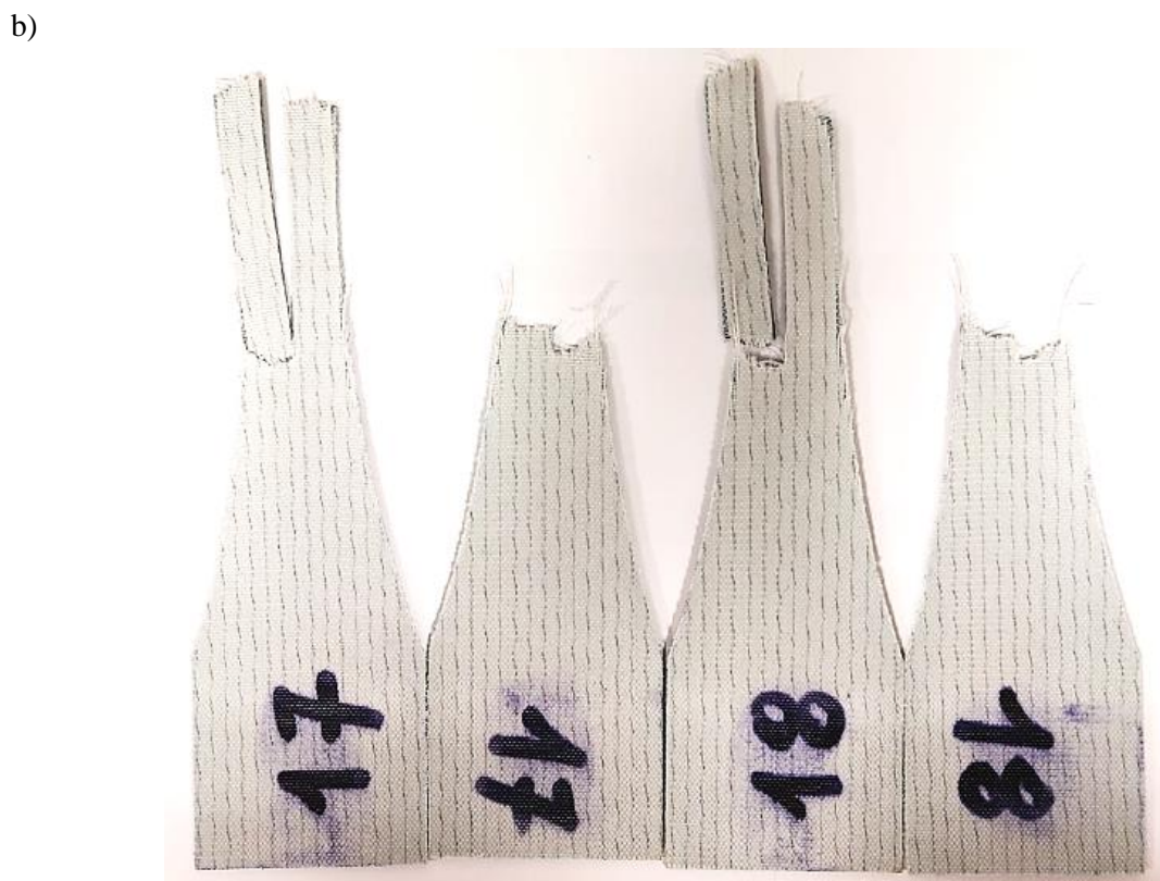
Rys. 5.142. Wyniki statycznego rozciągania, uszkodzenie UW II a) wykres, b) zdjęcia próbek po zerwaniu (oprac. własne)
