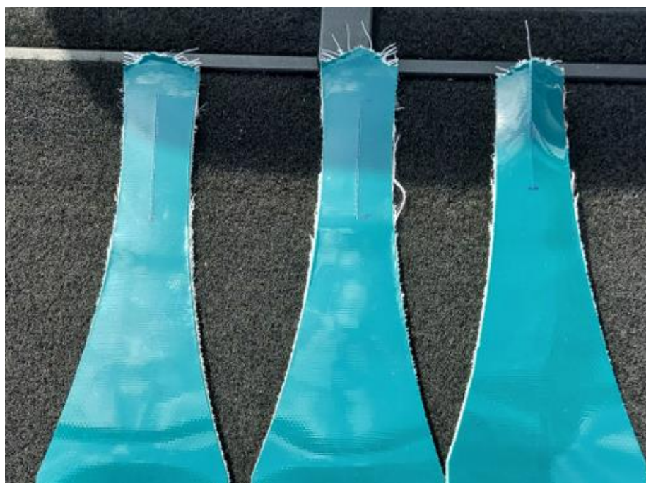
Rys. 5.145. Zerwane próbki, typ uszkodzenia UW III (oprac. własne)
