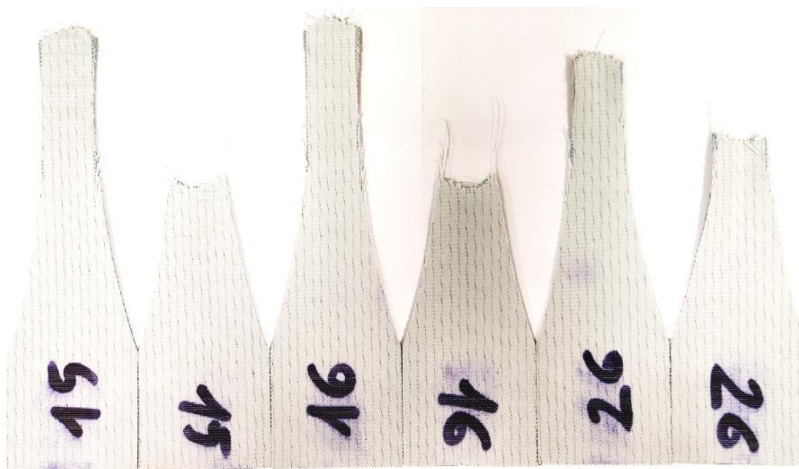
Rys. 5.143. Wyniki statycznego rozciągania, uszkodzenie UW III a) wykres, b) zdjęcia próbek po zerwaniu (oprac. własne)
