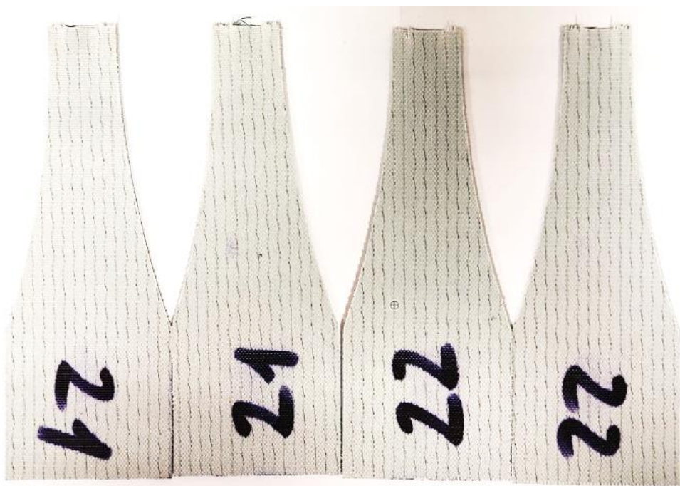
Rys. 5.139. Wyniki statycznego rozciągania, uszkodzenie UP I a) wykres, b) zdjęcia próbek po zerwaniu (Ryba i in., 2024)
