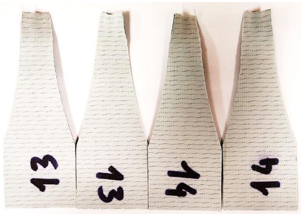
Rys. 5.140. Wyniki statycznego rozciągania, uszkodzenie UP I POPRZ .
