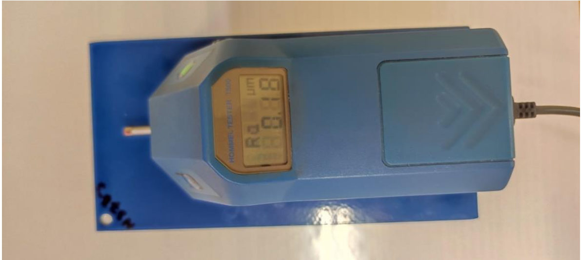
Rys. 3.6. Tester Hommel T500 do pomiaru chropowatości powierzchni
