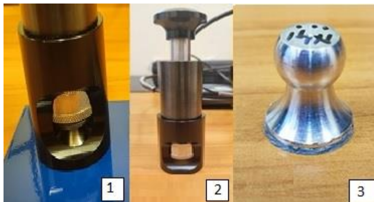
Rys. 7.2. Uchwyt z zamocowanym stemplem pomiarowym, zastosowany w badaniach adhezji (metodą odrywową) powłok epoksydowych do stalowego podłoża (1): 2 – uchwyt do odrywania stempli pomiarowych, 3 – stempel pomiarowy
