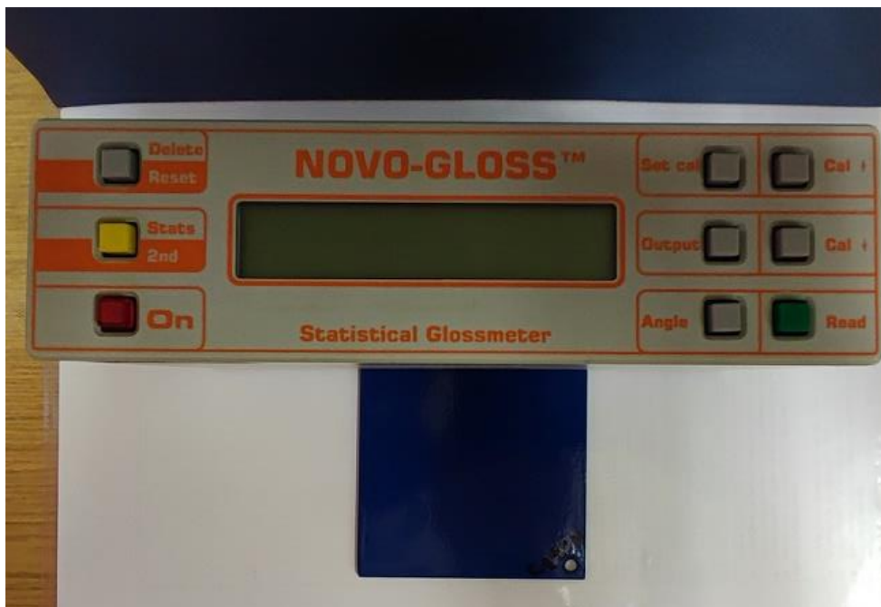
Rys. 3.7. Połyskomierz NOVO-GLOSS Elcometer 402 do badania połysku lustrzanego powłok polimerowych
