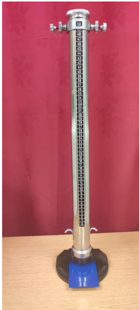
Rys. 8.2. Aparat Du Ponta do oceny odporności na uderzenie powłok polimerowych
