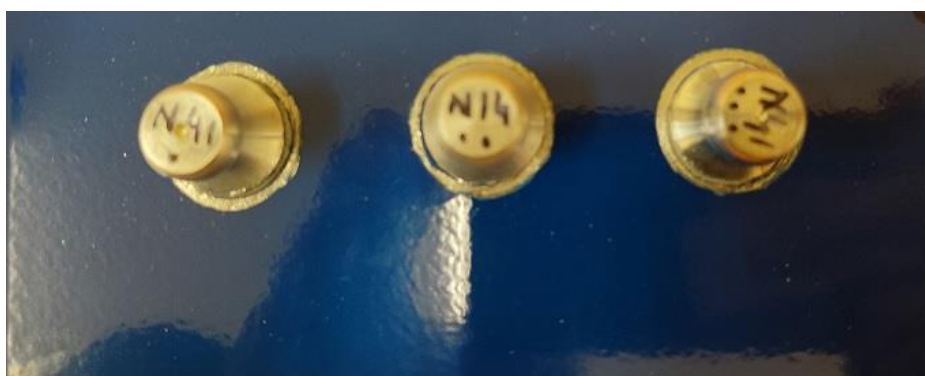
Rys. 7.1. Powłoka epoksydowa z przyklejonymi stemplami pomiarowymi stosowanymi w badaniach adhezji metodą odrywową
