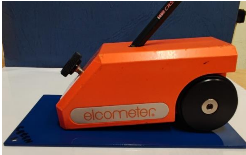
Rys. 3.9. Przyrząd do badania twardości powłok polimerowych metodą ołówkową
