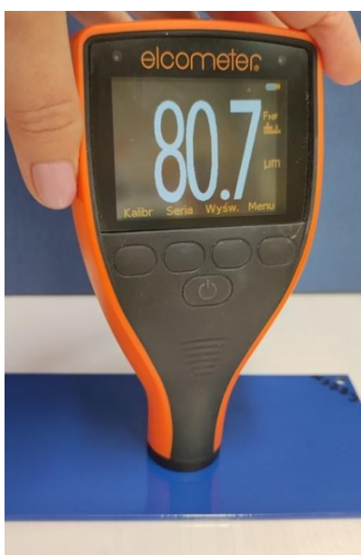
Rys. 3.5. Miernik grubości powłok Elcometer 456C
