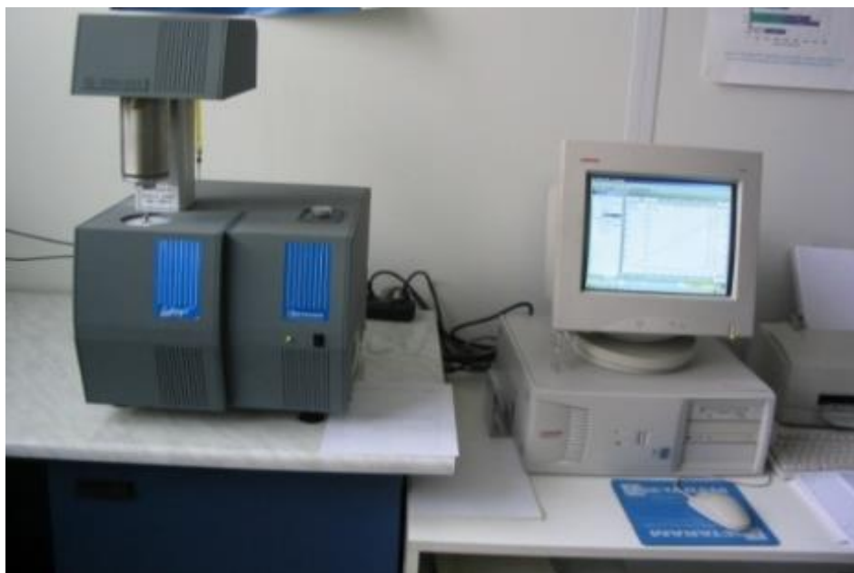
Rys. 3.18. Analizator termiczny LABSystem TG /DSC (firmy SETARAM)
