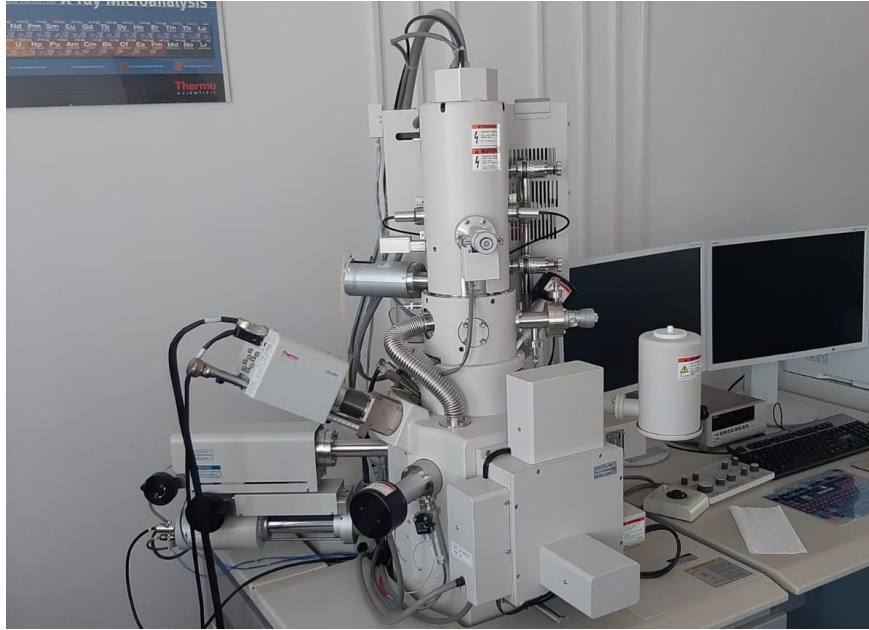
Rys. 3.15. Skaningowy mikroskop elektronowy (SEM) z emisją polową model SU-70 firmy Hitachi z mikroanalizatorem rentgenowskim firmy Thermo Scientific
