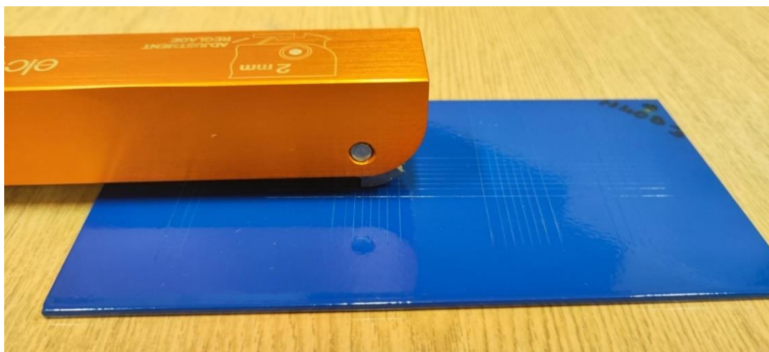
Rys. 3.12. Wykonywanie nożem krążkowym siatki nacięć na powłoce epoksydowej
