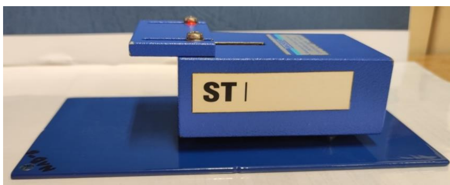
Rys. 3.8. Aparat do badania twardości powłok polimerowych metodą Buchholza
