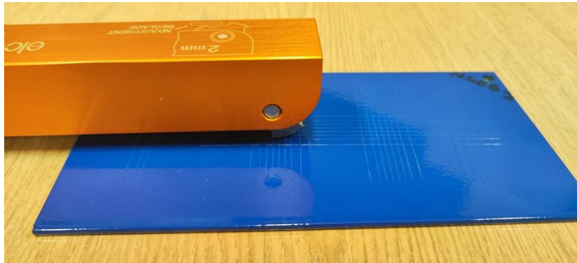
Rys. 7.4. Wykonywanie nożem krążkowym siatki nacięć na powłoce epoksydowej
