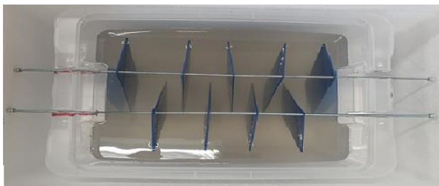
Rys. 3.4. Zbiornik z powłokami epoksydowymi zanurzonymi w 25% chlorku sodu
