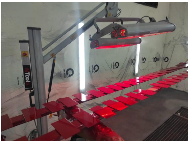
Rys. 3.5. Stanowisko suszenia promiennikami podczerwieni pneumatycznie naniesionych na podłożu stalowym powłok akrylowo-epoksydowych
