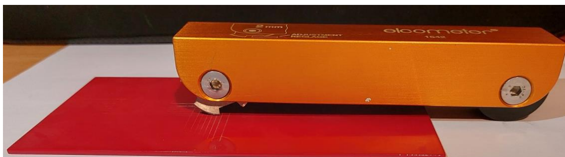
Rys. 6.1. Wykonywanie nożem krążkowym siatki nacięć na powłoce akrylowo-epoksydowej
