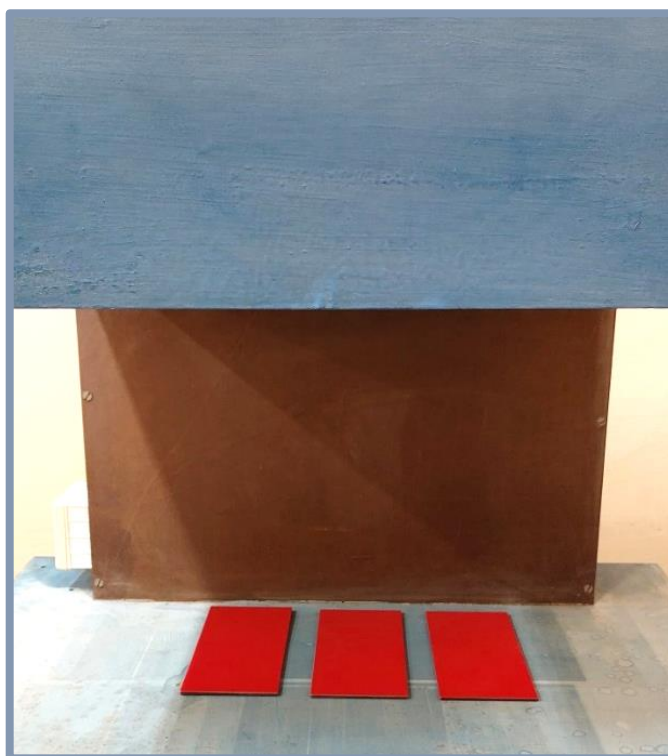
Rys. 3.13. Starzenie powłok akrylowo-epoksydowych pod wpływem promieniowania UV
