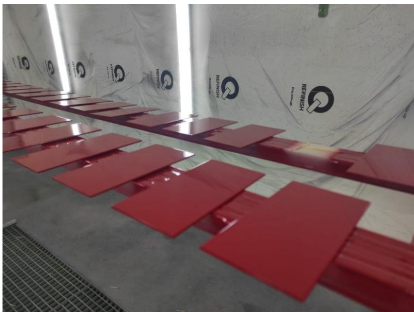
Rys. 3.3. Próbki z systemem powłok akrylowo-epoksydowych naniesione pistoletem pneumatycznym na powierzchnię płytek stalowych
