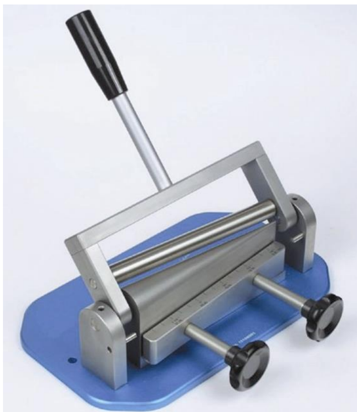
Rys. 6.4. Aparat do badania odporności na zginanie powłok polimerowych na sworzniu stożkowym
