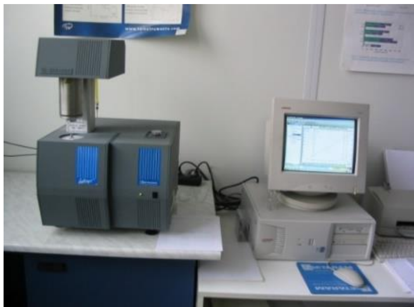
Rys. 3.8. Analizator termiczny LABSystem SETARAM TG DSC
