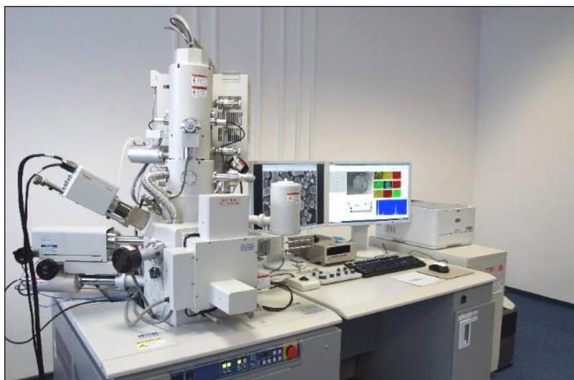
Rys. 3.6. Skaningowy mikroskop elektronowy z emisją polową model SU-70 (firmy Hitachi) z mikroanalizatorem rentgenowskim firmy Thermo Scientific
