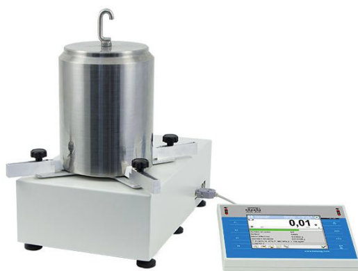
Rysunek 27: Komparator zbudowany na bazie mechanizmu wagi ciężkiej o zakresie komparacji w zależności od modelu 100 g – 64 kg (źródło: Radwag, 2021).
