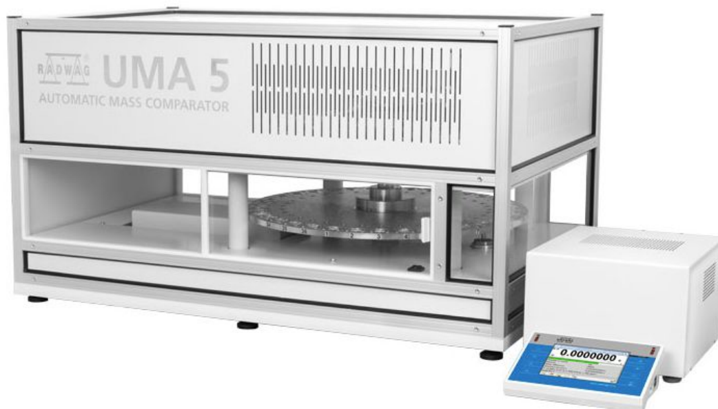
Rysunek 35: 36-pozycyjny komparator automatyczny (źródło: Radwag, 2021).
