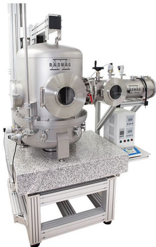
Rysunek 38: Komparator próżniowy o maksymalnym udźwigu 1kg i rozdzielczości 0,1 \mu\text{g} (źródło: Radwag, 2021).
