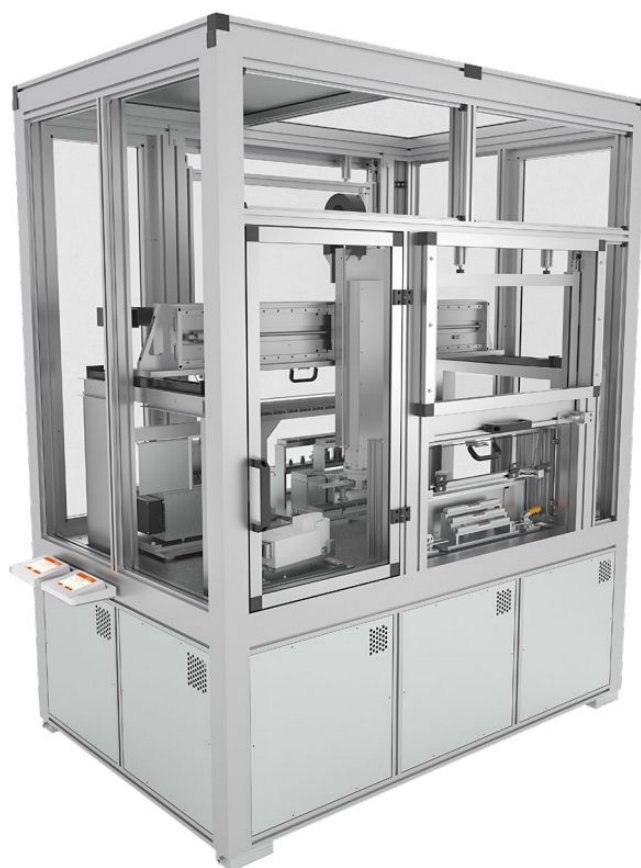
Rysunek 37: Hybryda komparatora robotycznego z automatycznym modułem komparatora masy o maksymalnym udźwigu 1100 g (źródło: Sartorius, 2021).
