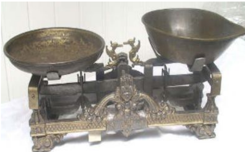
Rysunek 6: Waga prosto-dźwigniowa konstrukcji Josepha Berangera (źródło: http://members.upcpoczta.pl/z.kwiatkowski99/ws-rob.html )
