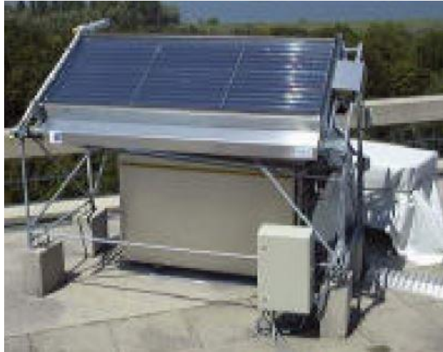
Rys. 3.22. Widok solarnego adsorpcyjnego urządzenia chłodniczego [78]
