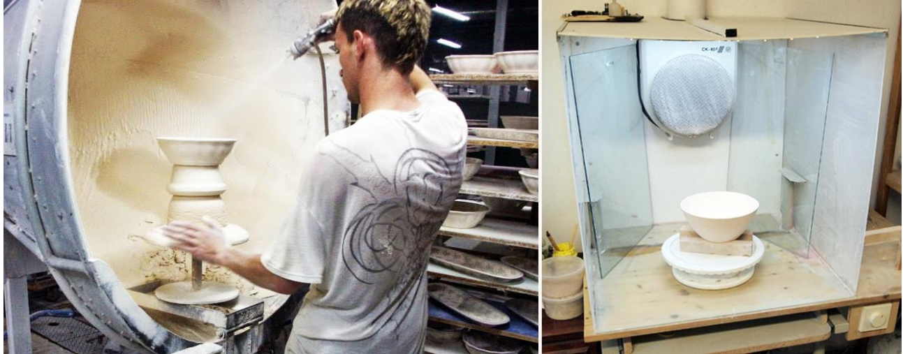
Fot. 8. Proces szkliwienia natryskowego oraz komora do natrysku szkliwa https://www.bocian.works/komora-do-szklwienia-natryskowego/ https://malujceramike.blogspot.com/2014/09/bolesawiec.html
