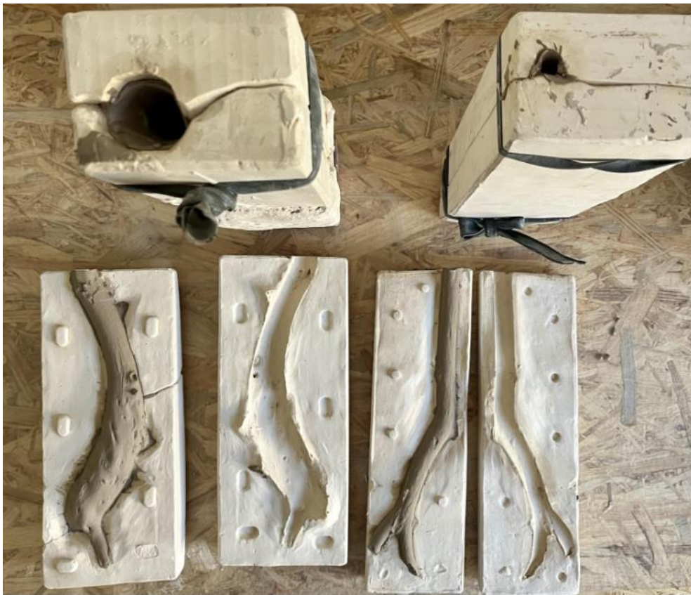
il. 39: Odlewanie gałęzi z masy ceramicznej do gipsowych form
