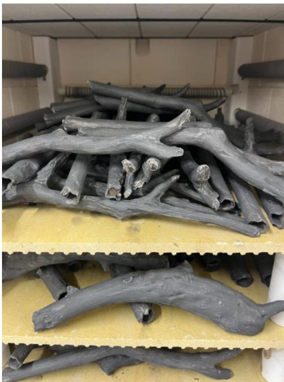
il. 42: Odlewy przygotowane do wypału ostrego
